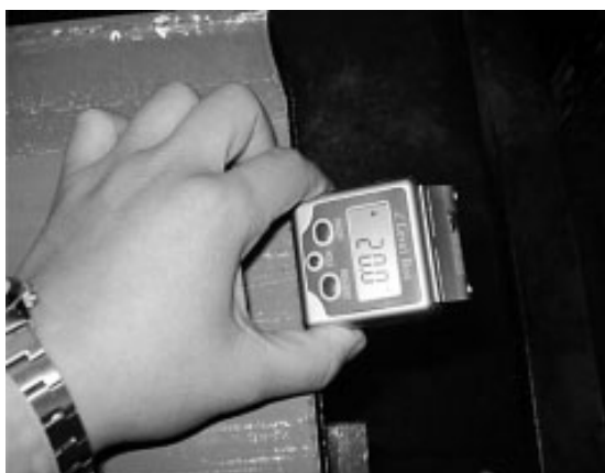
图 6 型钢坡口切割测试
