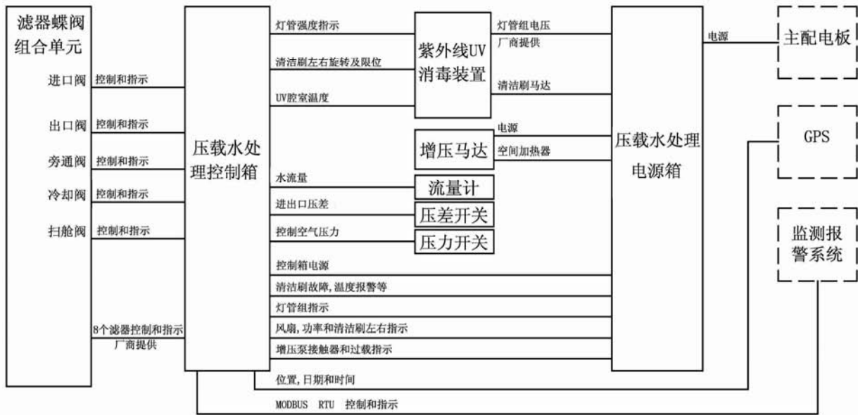
图1 压载水处理电气系统
