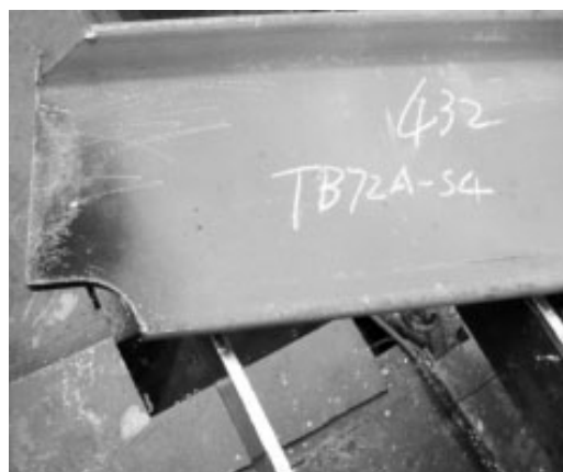
图 7 型钢端头削斜测试
